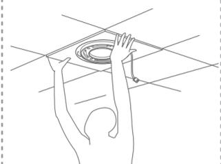
6. 先用网线连接AP, 再对齐安装架和AP, 注意卡口对准长卡槽
