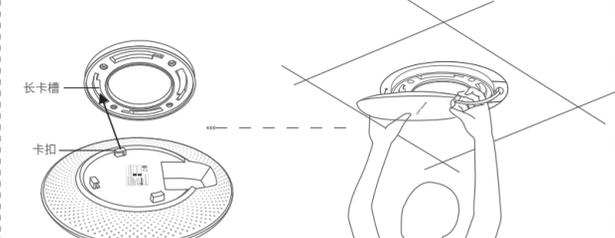
7. 将AP嵌入到安装架上, 再顺时针方向旋转固定AP, 完成安装
