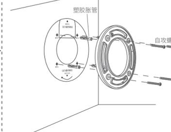
4. 先用网线连接AP, 再对齐安装架和AP, 注意卡口对准长卡槽
