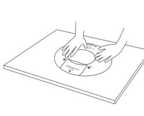
3. AP采用PoE供电, 按照定位贴上标记的位置, 钻4个直径为4mm的螺钉孔, 钻一个直径为10mm的网线孔
