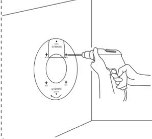
3. 将安装架用塑胶胀管和自攻螺钉固定到墙面上
