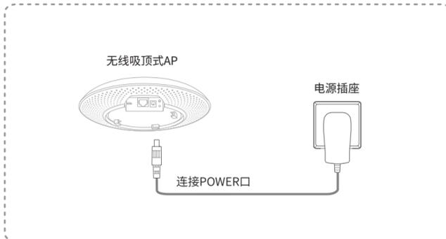
◆接通电源后，AP将自动进行初始化，此时系统指示灯先是常亮，初始化完成后，会闪烁2秒，待系统指示灯再次常亮，表示设备已正常工作。指示灯含义说明请参考产品介绍中的系统指示灯含义列表。
