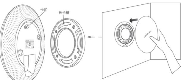
5. 将AP嵌入到安装架上, 再顺时针方向旋转固定AP
